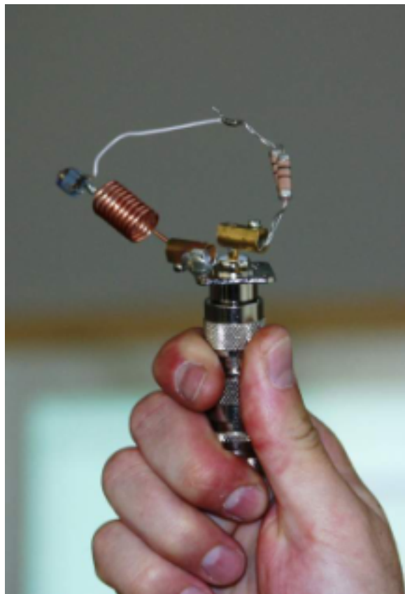
foto 5: Circuito resonante serie R-L-C para realizar trampas.
