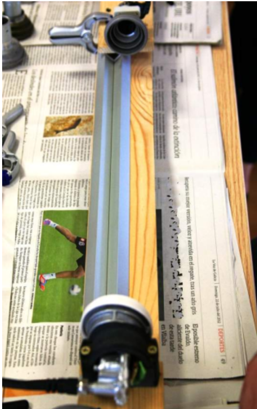
foto 10: El Microtrain-er con los módulos TX y RX de 10 GHz.
